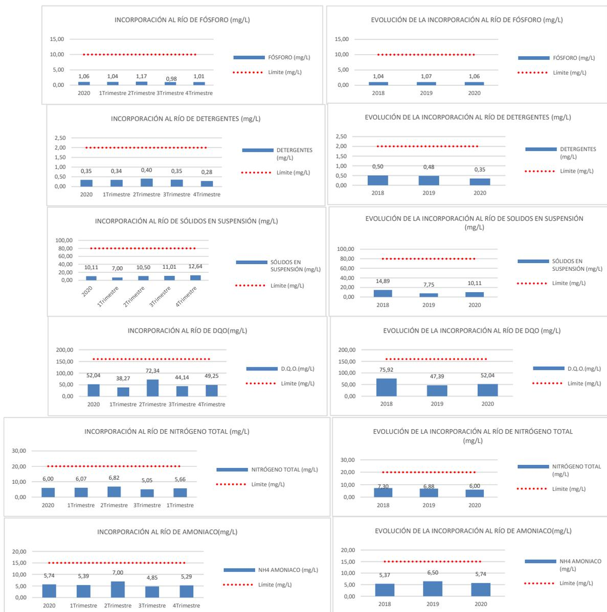
Como consecuencia de la aplicación desde 2010 de la autorización de vertido vigente, que incorporó como nuevos parámetros el amoniac y el Nitrógeno total y que eliminó como parámetro a controlar los cloruros, durante 2012 se realizó una serie de mejoras en la planta de fecales como proceso de adaptación de la misma a la autorización de vertido, con objeto de reducir la concentración (mg/l) tanto de amoniac como de Nitrógeno total.
